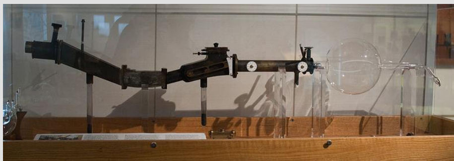
THOMSONS Massenspektrometer (Nachbau)
