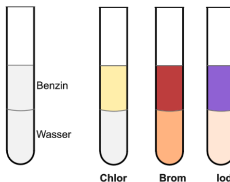
Lösungs-Verhalten von einigen Halogenen in einem Zwei-Phasen-System aus Benzin und Wasser
