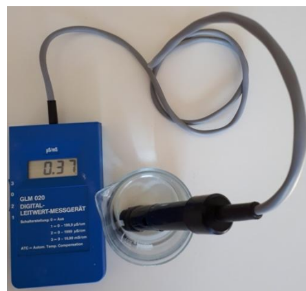
Leitfähigkeits-Messgerät mit eingetauchter Elektrode
