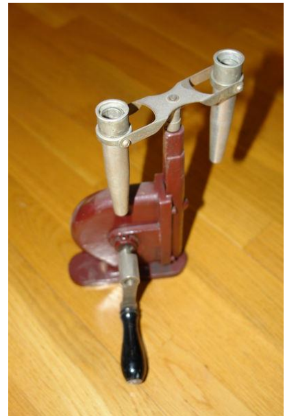
einfache Hand-betriebene Zentrifuge Q: de.wikipedia.org (Stephan M.Höhne)
