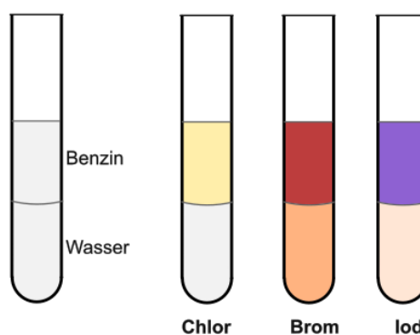
unterschiedliche Färbungen bei einer Extraktion von Halogenen
