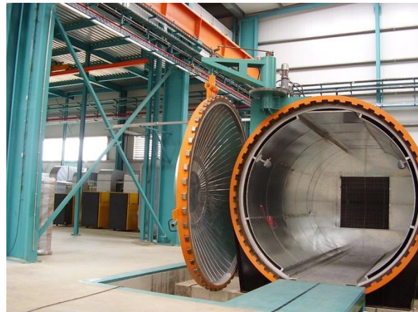
Autoklav zur Herstellung von Verbund-Glas (auch Sicherheits-Glas genannt) Q: de.wikipedia.org (JaviRD)
