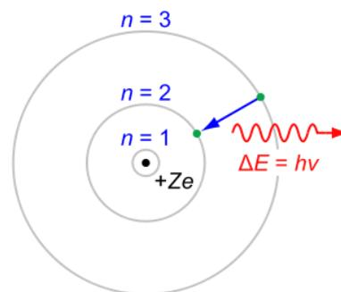
BOHRsches Atom-Modell für das Wasserstoff-Atom
