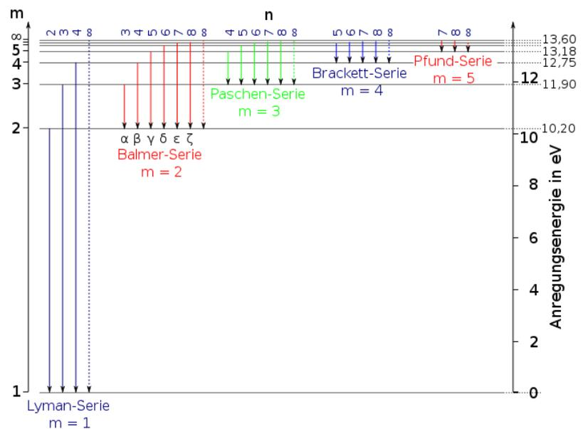
mögliche Elektronen-Übergänge (Term-Schemata) für Wasserstoff
