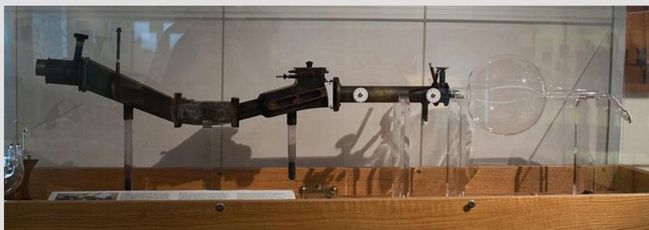
THOMSONS Massenspektrometer (Nachbau)
