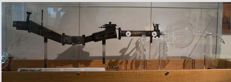
THOMSONS Massenspektrometer (Nachbau)
