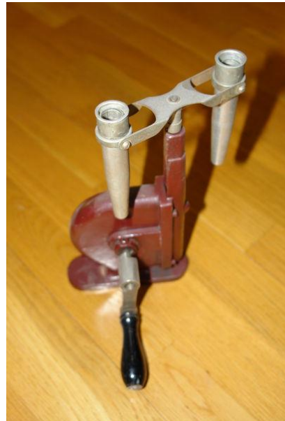
einfache Hand-betriebene Zentrifuge Q: de.wikipedia.org (Stephan M.Höhne)
