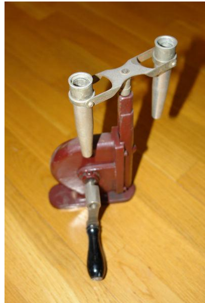
einfache Hand-betriebene Zentrifuge Q: de.wikipedia.org (Stephan M.Höhne)
