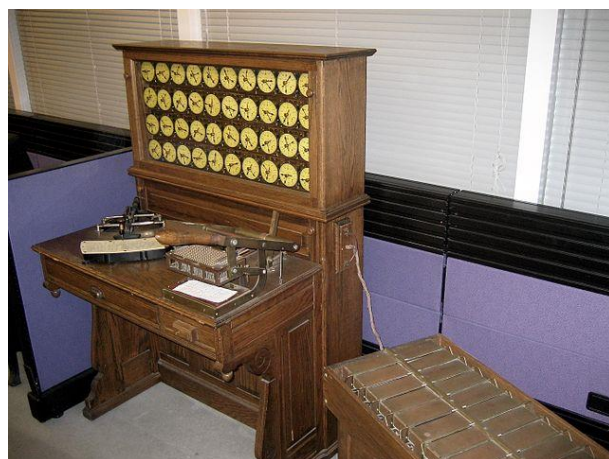
HOLLERITH-Maschine mit Zählwerk (an der Wand), Lochkarten-Stanzer auf dem Tisch und einem Lochkarten-Sortierer (rechts vorne) Q: de.wikipedia.org (Adam Schuster (www.flickr.com))
