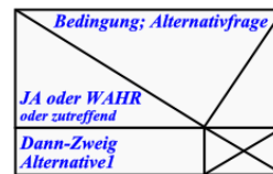
Struktogramm-Symbol einer einfachen Verzweigung (bedingte Ausführung)
